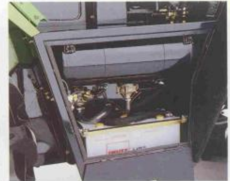
Pour contrôler la batterie, il suffit d'ouvrir la trappe de visite.
