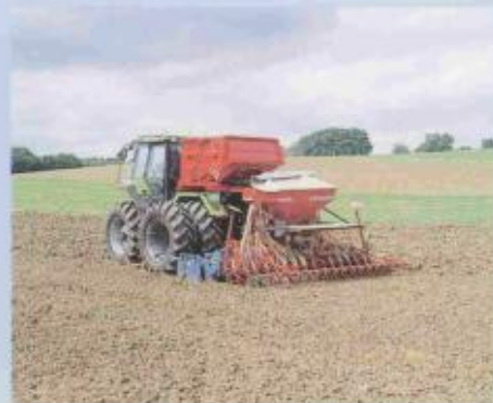
Relevage AR puissant pour combinaisons d'outils de préparation sans détérioration du sol.
