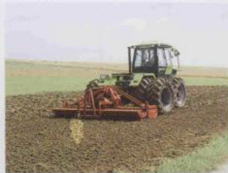
Préparation des lits de semences sans détérioration du sol à l'aide d'une herse rotative de 4 m.
