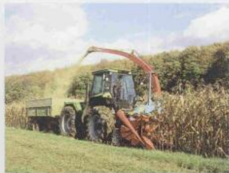
Vue entièrement dégagée sur l'ensileuse à maïs en attelage frontal.
