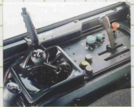
Leviers d'embrayage pour pdf AR et EHR placés à portée de main.
