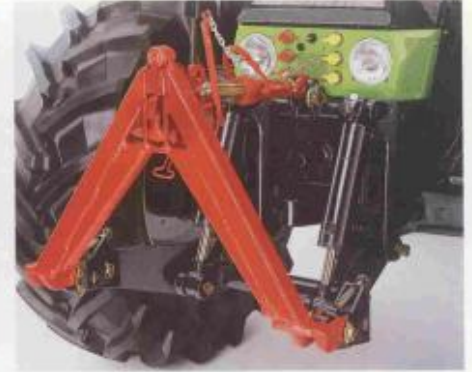
Relevage AV et jusqu'à 6 raccords hydrauliques.
