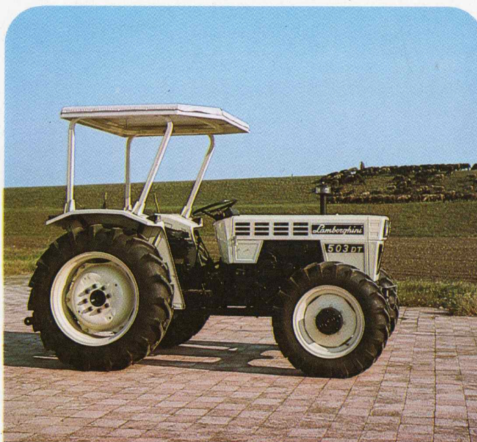
503 Motor: 3 cilindres / 47 PK DIN / Gesynchroniseerde versnelling: vooruit 12 + achteruit 3 / Koppeling: dubbel / Aftakas: onafhankelijk - 540-1000 t.p.m. - gesynchroniseerd / Gewicht: 2050 kg.
