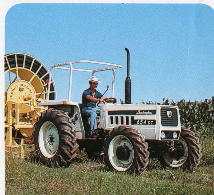
654 Motor: 4 cilindres / 67 PK DIN / Gesynchroniseerde versnelling: vooruit 12 + achteruit 3 / Koppeling: dubbel / Aftakas: onafhankelijk - 540-1000 t.p.m. - gesynchroniseerd / Gewicht: 2865 kg.
