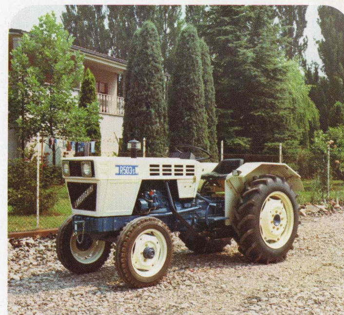
503 S Motor: 3 cilindres / 47 PK DIN / Gesynchroniseerde versnelling: vooruit 12 + achteruit 3 / Koppeling: dubbel / Aftakas: onafhankelijk - 540-1000 t.p.m. - gesyn. / Gewicht: 1830 kg.
