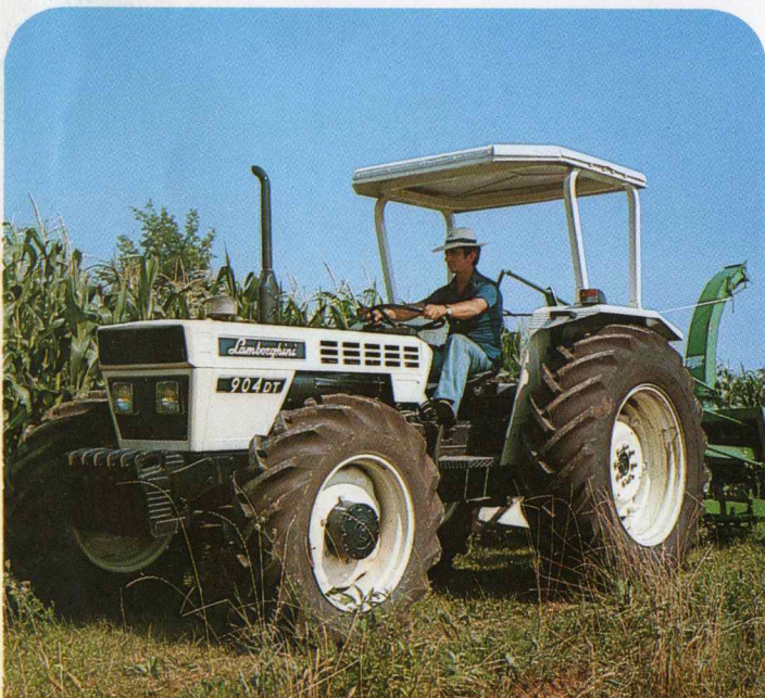
904 Motor: 4 cilindres / 92 PK DIN / Gesynchroniseerde versnelling: vooruit 12 + achteruit 3 / Koppeling: dubbel / Aftakas: onafhankelijk - 540-1000 t.p.m. - gesynchroniseerd / Gewicht: 3610 kg.
