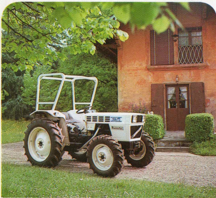
235 Motor: 2 cilindres / 34 PK DIN / Versnelling: vooruit 6 + achteruit 2 / Koppeling: dubbel / Aftakas: onafhankelijk - 540 t.p.m. - gesynchroniseerd / Gewicht: 1420 kg.
