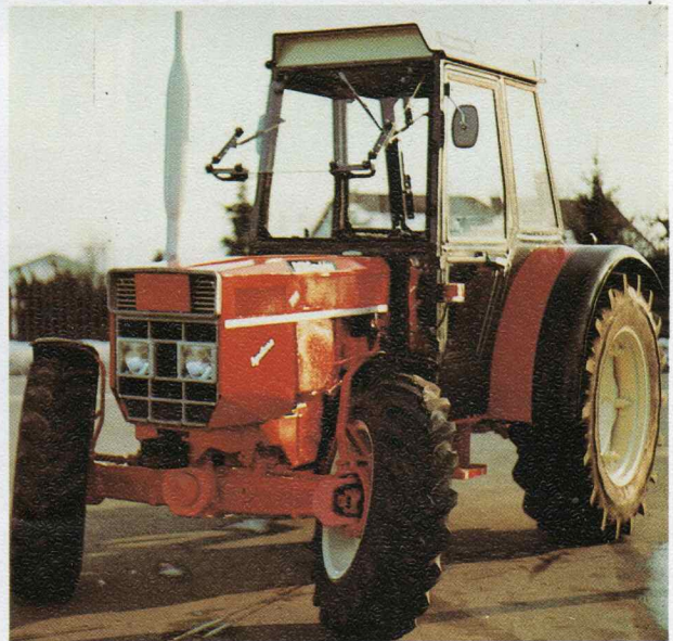
BERGmeister ausgerüstet mit ZF-Lenkachse einschließlich Locomatic, besonders großer Lenkeinschlag bis 50 Gr. vorläufig ab 1,60 m Außenbreite lieferbar.
