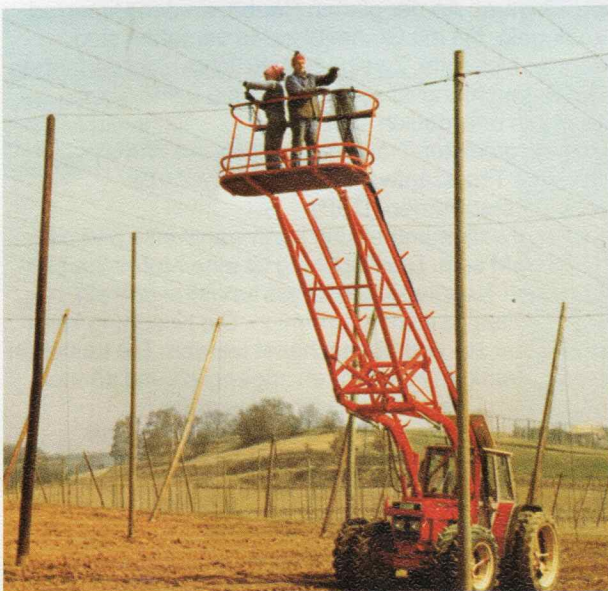
Spezialhopfenschlepper für Hopfengroßraumanlagen 754 (75 PS) oder 854 (85 PS) mit Kabine, Zwillingbereifung und Frontlader mit Hopfenkanzel.
