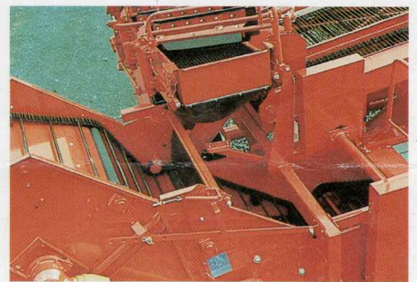
Das „Herz“ der SL 750: 2. Siebband (rechts), weitmaschiges Krautband (Mitte unten nach links), Trenngerät G (Mitte oben) und Verlesemit Beimengenband (rechts oben)
