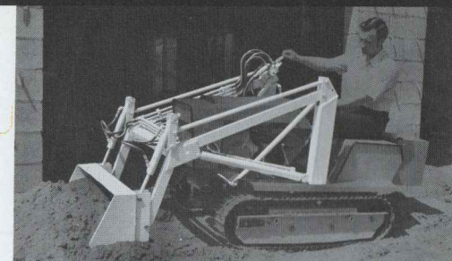
A. HYDRAULIC LOADER
