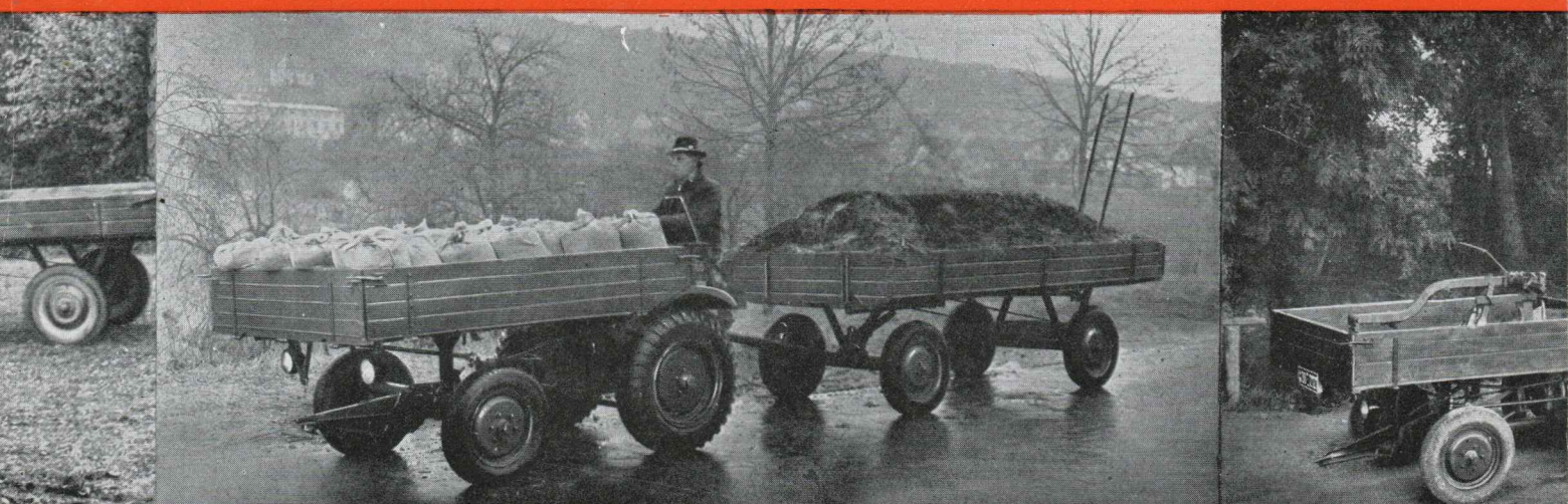
Der robuste 2 to-GUTBROD-Ackerwagen mit Kugelenkung, zuverlässig wirkender Aufaufbremse und Deichselfallbremse ist eine wertvolle Ergänzung des FARMAX. Der FARMAX kann mit seinen Anhängern selbst zum Feld fahren.
