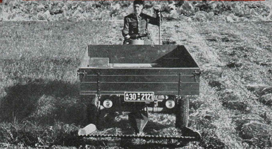
Die überragenden Vorzüge des über 20000-fach bewährten GUTBROD-Vorausmähers sind auch im FARMAX verwirklicht. Der 1,70 m breite Messerbalken wird mit praktischer Einhebelbedienung leicht eingesetzt und ausgehoben.
