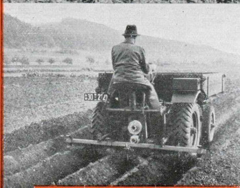
Der FARMAX ermöglicht eine höhere Flächenleistung beim Kartoffelpflanzen durch gleichzeitige Drei-Reihen-Bearbeitung mit Pflanzlochsternen und nachfolgenden Häufelkörpern. Der Fahrer hat stets eine gute Sicht auf die Geräte.
