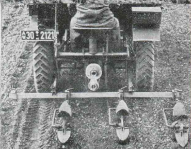
Der FARMAX ermöglicht eine höhere Flächenleistung beim Kartoffelpflanzen durch gleichzeitige Drei-Reihen-Bearbeitung mit Pflanzlochsternen und nachfolgenden Häufelkörpern. Der Fahrer hat stets eine gute Sicht auf die Geräte.
