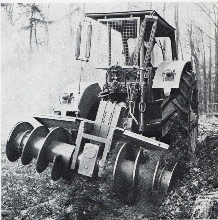
Anlegung von Pflanzriefen mit der Schneckenfräse
